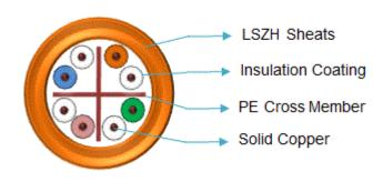
Conductor : Annealed Copper Conductor
